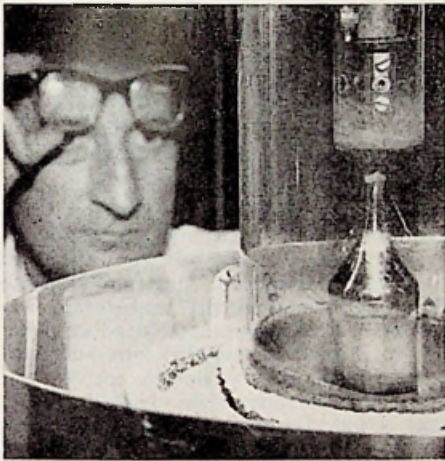
Close-up van een germanium-kristallisatiemachine. Uit de „smelt” wordt in een roterende beweging de germaniumstaaf getrokken
