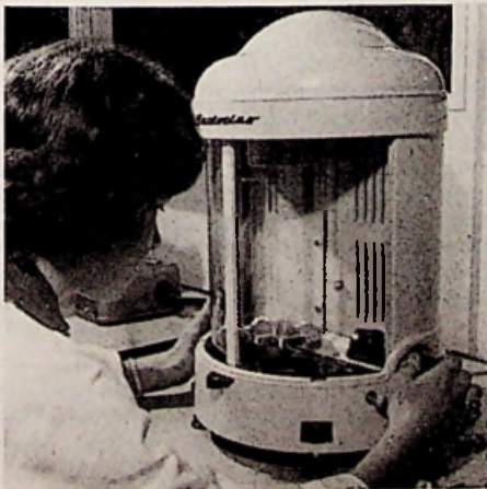
PRECISIE WEEGSCHAAL voor gewichtsbepaling van de verschillende onderdelen voor transistoren en dioden.
